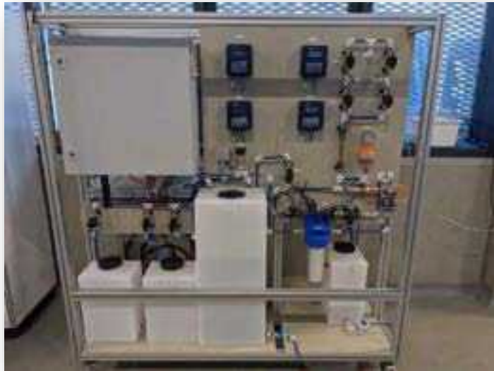
Anlage im Labormaßstab für Entsalzungsversuche. Erstellt von DEUKUM GmbH und elkoplan staiger GmbH
