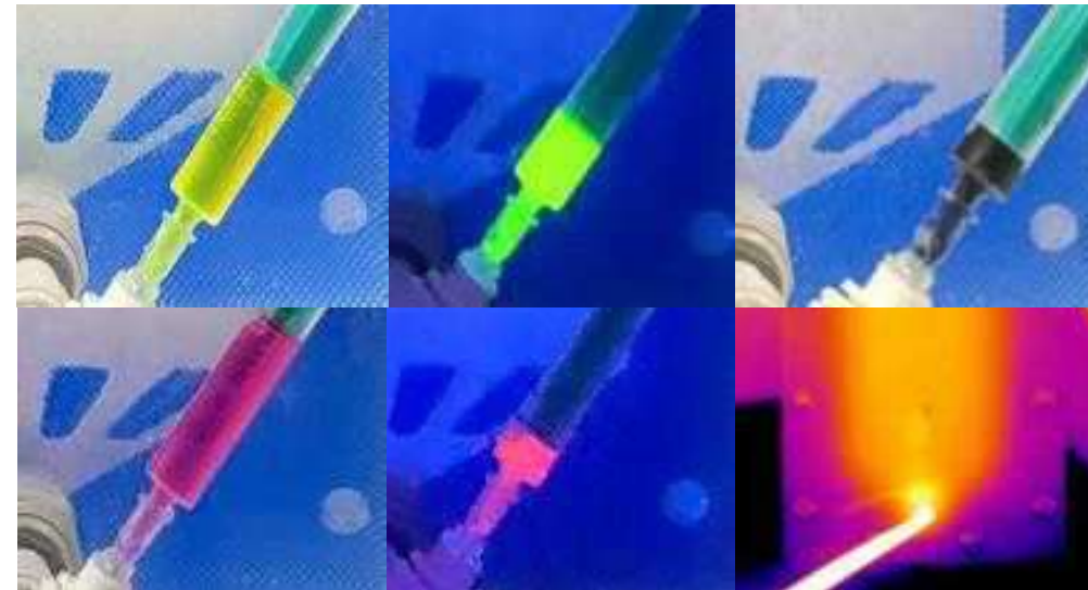
Tracer (v. l. n. r.): Uranin, Uranin+UV, Tine (Oben), Rhodamin B, Rhodamin B+UV, Tine (Unten)
